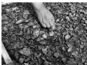
図12 流下盤に敷き詰められた砂利 (愛媛県新居浜市ソルティエ多喜浜; 2018年6月撮影)
