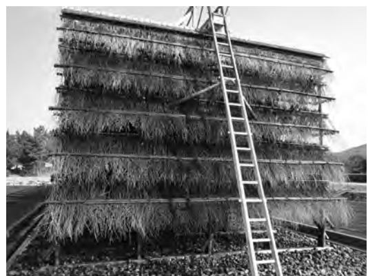
図11 流下式枝条架併用塩田 (兵庫県赤穂市赤穂海浜公園; 2012年1月撮影)
